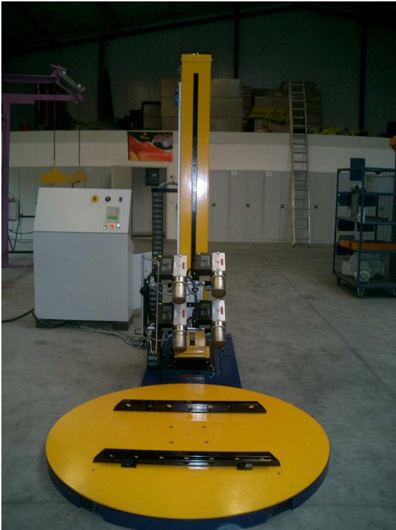
Abbildung zeigt den SchrumpfLIFT elektrisch Mit 4 Heißluftstrahlern
