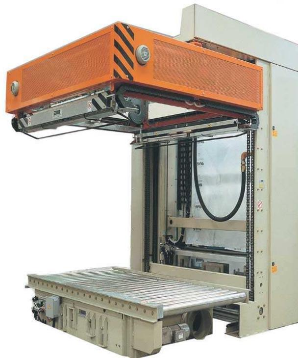
Der Haubenschrapper des Typs AT53 ist eine besonders wirtschaftliche Art der Transportsicherung mittels einer Haube aus Schrupffolie.
